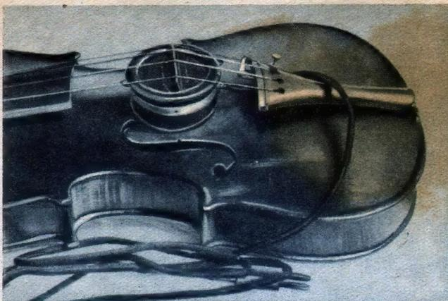
Abb. 8. Der Geigentonabnehmer spielfertig. Die Litze braucht nur noch mit den Tonabnehmerbuchsen des Rundfunkempfängers oder mit einem Verstärker verbunden zu werden.
